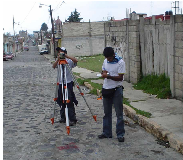
Fig. IV.11. Nivelación de eje y secciones.
