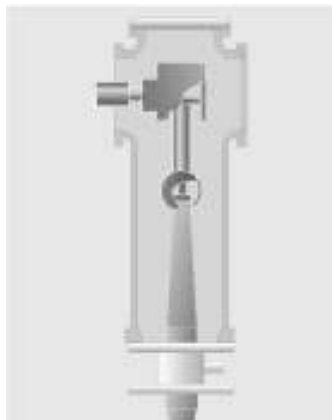
Figura 3.22. Módulo constructivo para empalme directo de la celda a transformadores aislados en aceite o reactores. Pueden ser conectados de forma económica a Transformadores de diversas dimensiones a través de módulos estandarizados.
