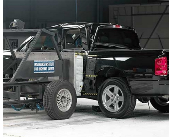
Imagen 3.2 Prueba física de Impacto "Lateral Barrier"
