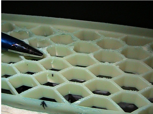
Imagen 4.6 Detalle de la zona de los honeycombs después de la prueba física
