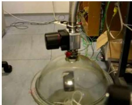
Figura 2-2 Pruebas de vacío a Smartphone [12]
