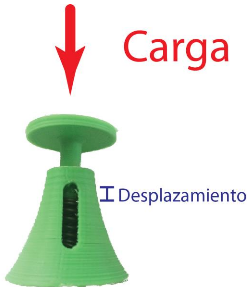
Ilustración 22 Banco para caracterización de resortes de 7.5mm de diámetro
