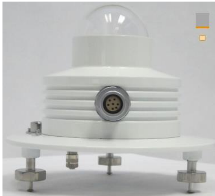
Figura 17. Sensor de radiación solar ultravioleta marca Solar Light, modelo 501A/B (según el filtro, tipo A o B).
