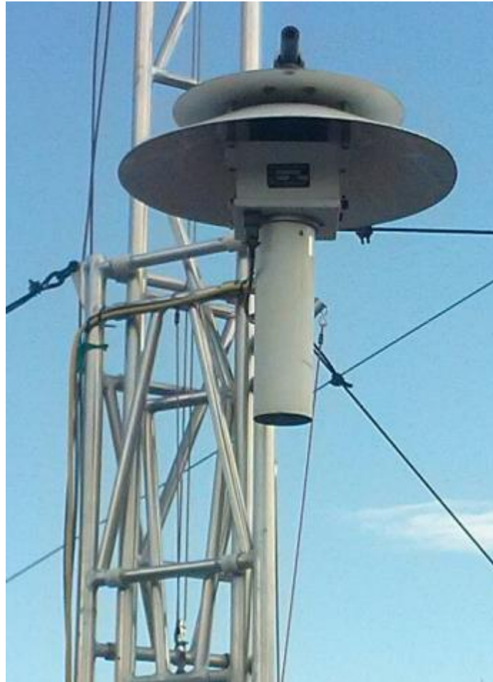
Figura 7: Blindaje de radiación solar para los sensores de temperatura y humedad relativa ambiente, tipo plato.
