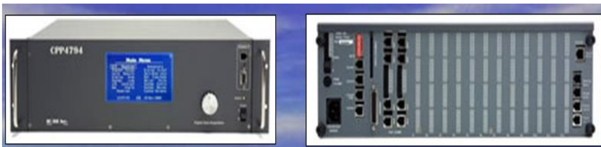
Figura 4.- Adquisidor de datos (CPP, del inglés Communications Protocol Processor) marca H2NS, modelo 4794.
