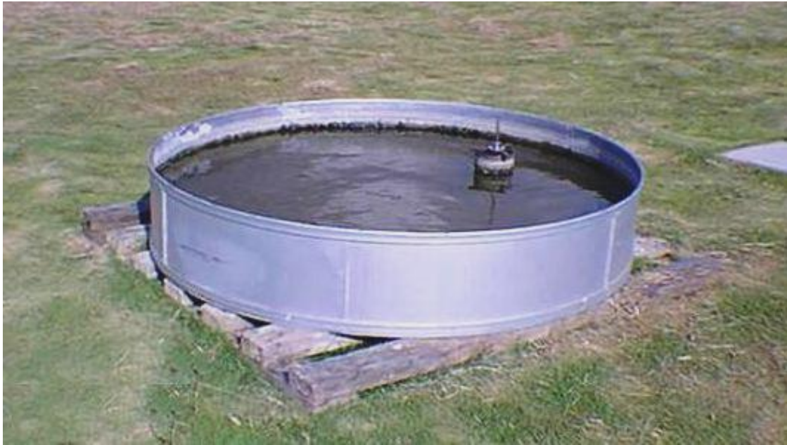
Figura 1. 7. Tanque de evaporación Fuente: http://www.ucla.edu/ve/ecla/equip.htm
