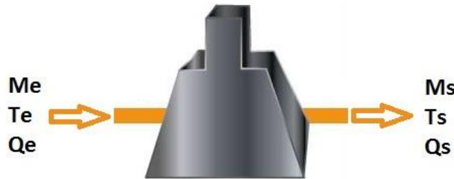
Figura IV.19 Balance de energía y masa en un horno
