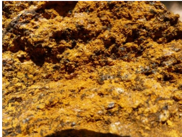
Figura 22. Oxidación presente en roca gabrónica se observa la alteración de los piroxenos.
