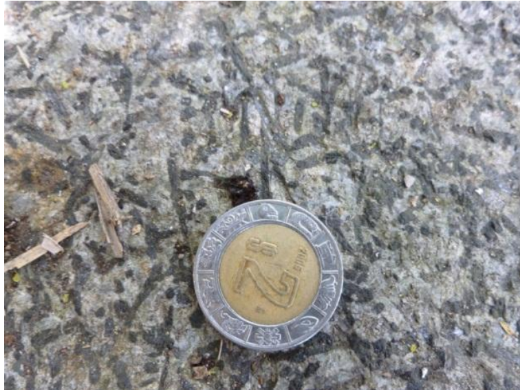
Figura 14. Muestra de mano de dique de fonolita en este se observan cristales aciculares de egirina-augita característicos de estas rocas.
