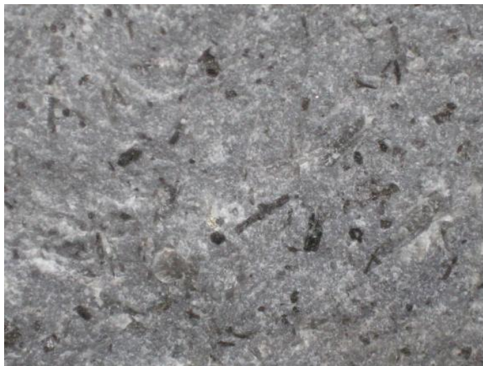
Figura 7. En esta imagen se observa el detalle la textura de la diorita que presenta cristales alargados de augita en una matriz de plagioclasas, foto tomada de muestra de mano.
