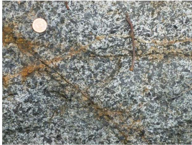
Figura 9. Foto de muestra de mano de la sienita donde se observa la textura fanerítica con una abundancia de minerales claros, esta tiene un color verdoso
