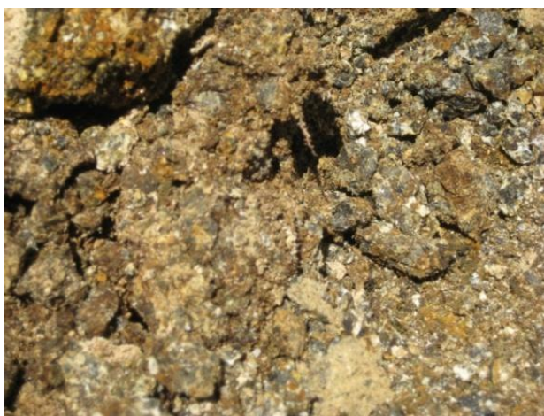
Figura 6. Gabro meteorizado el cual se altera a suelo con altas concentraciones de óxidos de hierro y minerales arcillosos.
