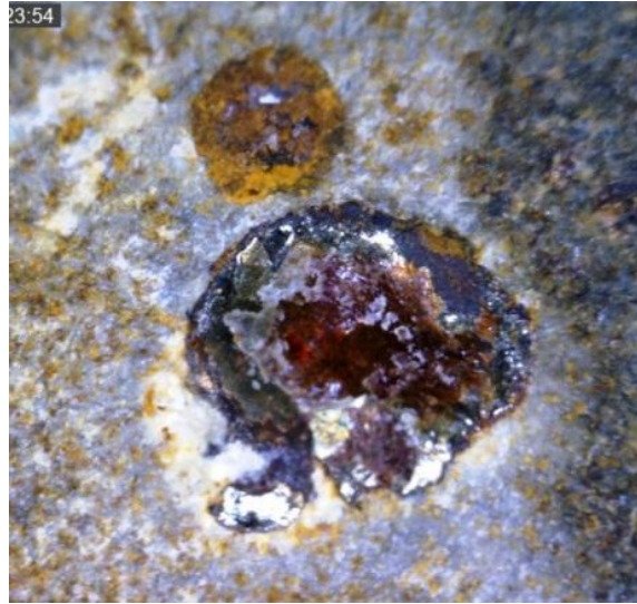
Figura 23. Se observa la alteración del piroxeno con bordes de reacción a anfíbol.
