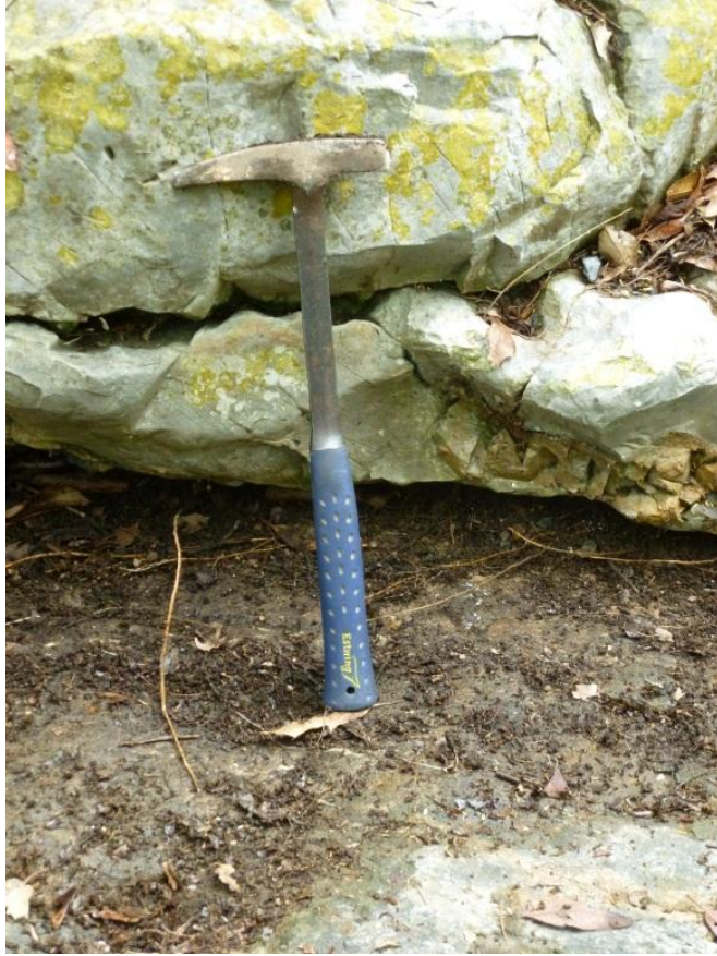
Figura 12. En la parte superior se encuentra la roca de origen sedimentario que sobreyace al granito el contacto entre ambas se encuentra sano al no presentar ningún tipo de alteración.
