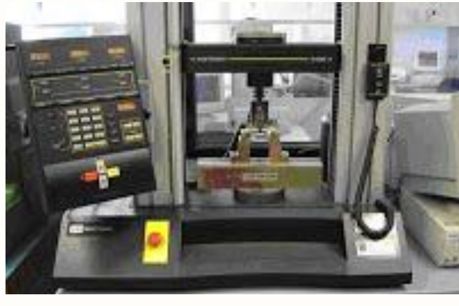
Fig. 3.5 Pruebas de flexión a la carga estática
