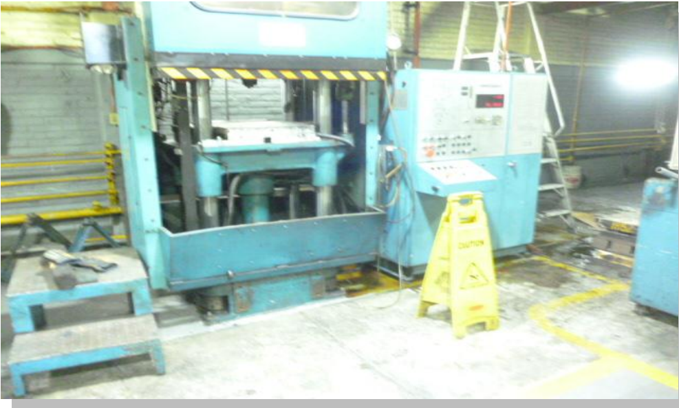
Fig. 3.7 Se observa en la imagen la unidad de cierre en los platos inferiores y superiores donde se encuentra el molde para el soporte automotriz.
