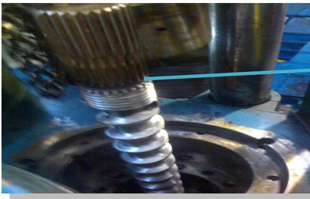
Fig. 3.13 Imagen del husillo de la máquina de inyección
