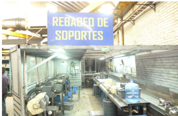
Fig. 3.4 Imagen del área de rebabeo, con las herramientas que se utilizan, esmeril y cuchillas.
