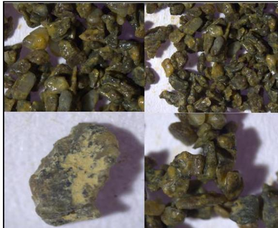
*Figura 6. 4. Recubrimiento de  $\text{Fe}(\text{OH})_3$  en CF2*
