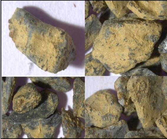
*Figura 6. 1. Recubrimiento de  $\text{Fe}(\text{OH})_3$  en F1*
