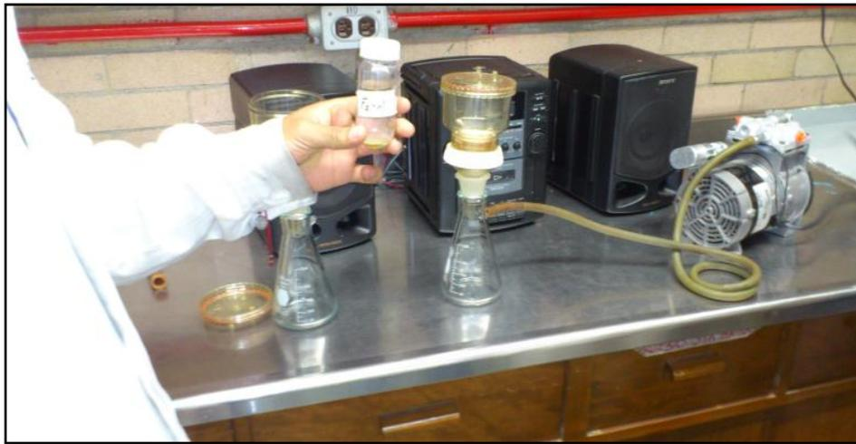
*Figura 5. 12. Etapa de filtrado con ayuda de una bomba de vacío*
