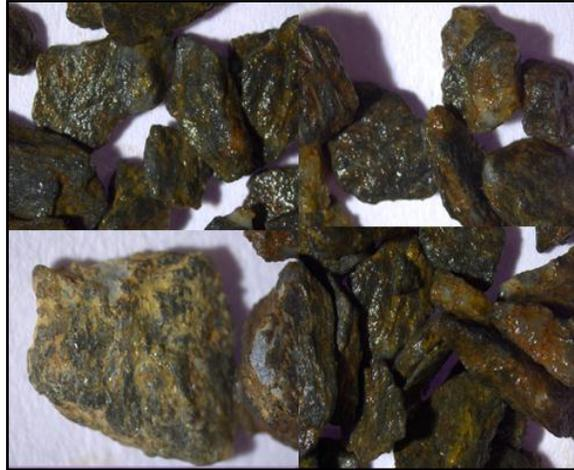
*Figura 6. 2. Recubrimiento de  $\text{Fe}(\text{OH})_3$  en F2*
