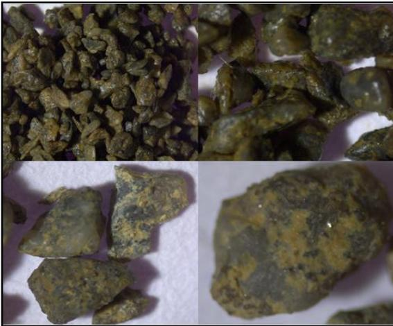
*Figura 6. 3. Recubrimiento de  $\text{Fe}(\text{OH})_3$  en CF1*
