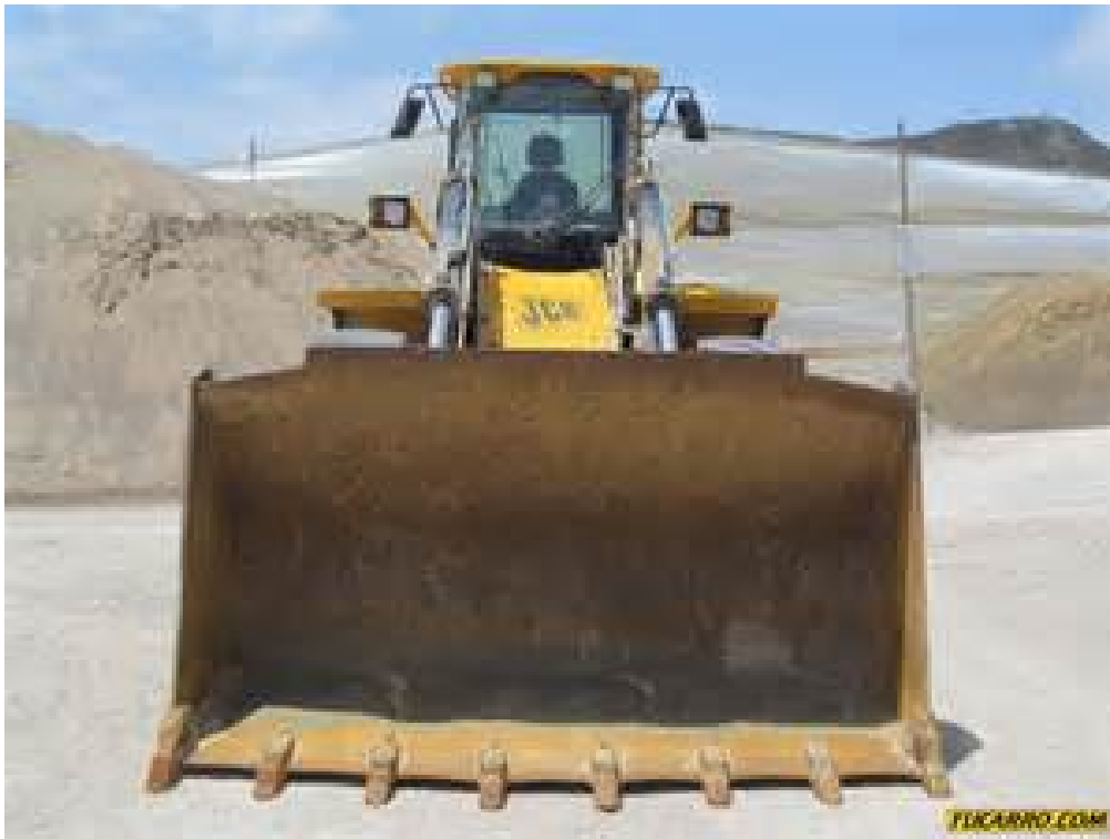
Foto No. 10 Cargador frontal para retiro de material excavado
