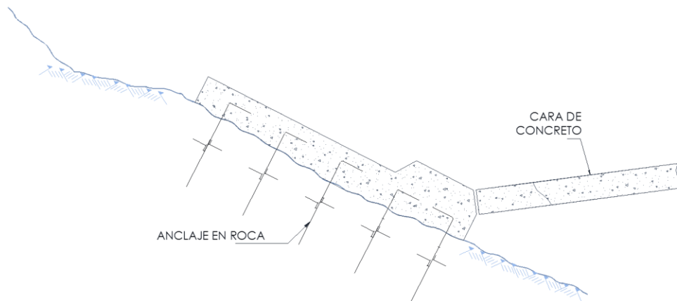
Figura 4-10 Plinto Inclinado (Machadinho)
