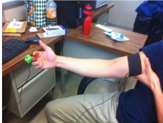
Figura 19. Ubicacion de sensores.
