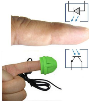
Figura 14. Sensores dentro del dedal; diodo y fototransistor.
