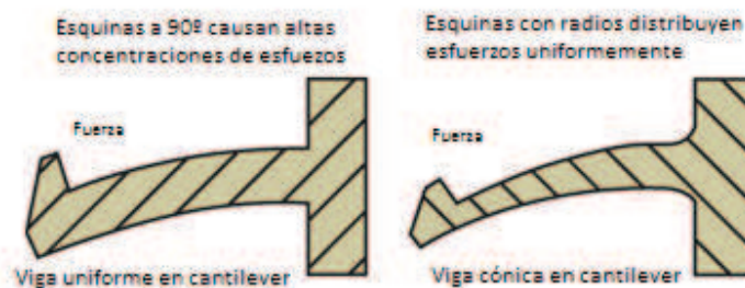
Fig. 25 Eliminación de acumulación de esfuerzos http://steinwall.le8.getliveedit.com/pages/DesignforSnaps
