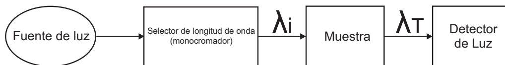
Figura 2.11: Estructura de un espectrofotómetro. \lambda_i es la longitud incidente y \lambda_T es la longitud transmitida [19].
