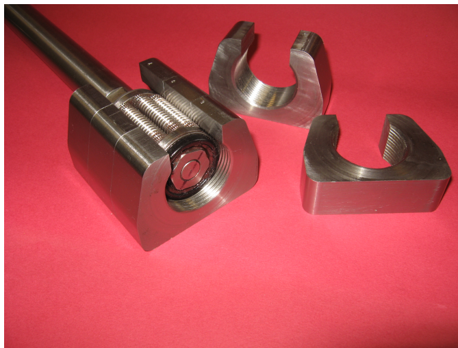
Figura 1.9. Tornillo de rodillos y cuerpos roscados
