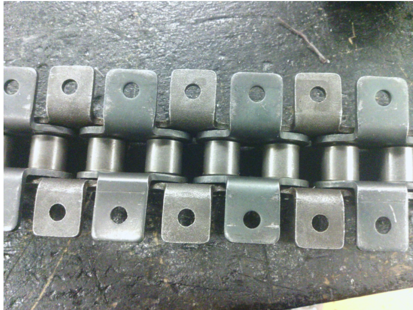
Figura 3.2. Cadena de rodillos comercial con aditamento K1
