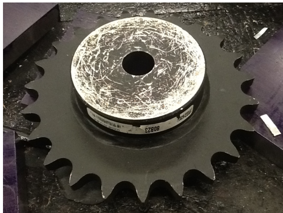
Figura 3.1. Rueda dentada de 23 dientes
