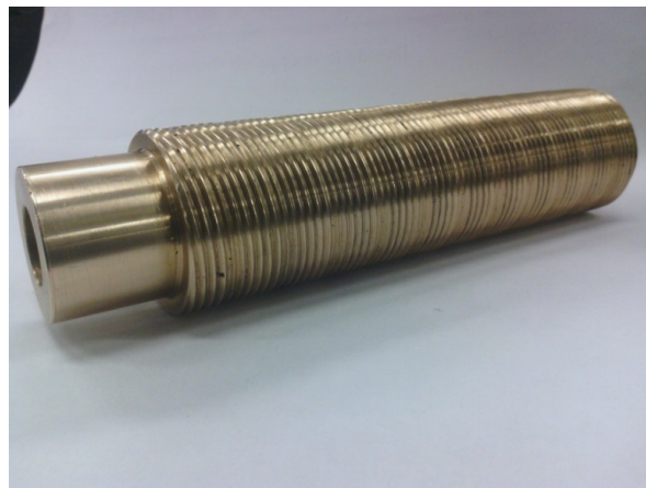
Figura 1.6. Tornillo de bronce fabricado para pruebas
