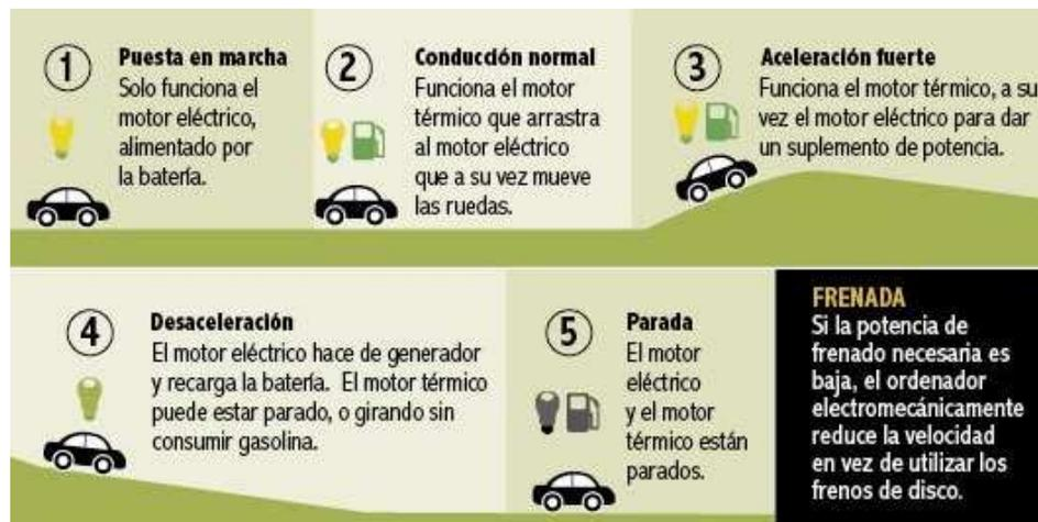
Figura 2.1: Funcionamiento de un VHE (infografía publicada en [www.mundoyomotor.com](http://www.mundoyomotor.com)).
