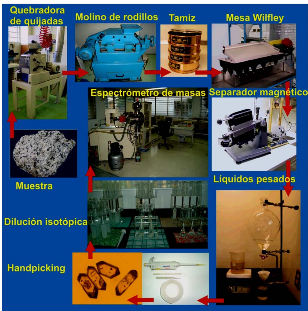
Figura 8. Técnica de separación de zircones para el análisis químico e isotópico de las muestras.
