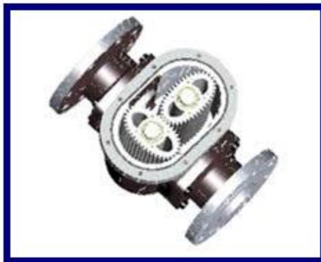
**Fig. 2.3.4. Medidor de rueda oval.**
