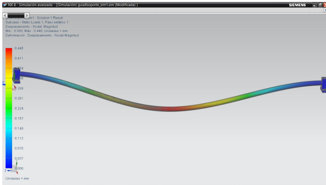
Figura 4.57. Desplazamiento (magnitud) de la guía X.
