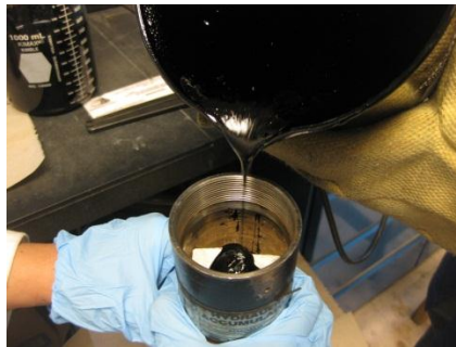
Figura 4.10 Celda con muestras de roca y aceite pesado.
