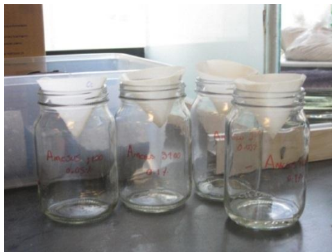
Figura 4.23 Filtración de las soluciones para recuperar el aceite expulsado de la roca.
