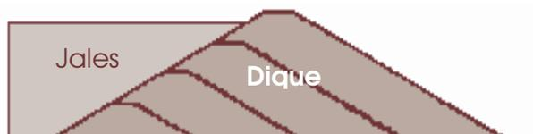
Figura 8. Método de construcción de una presa de jales denominado "aguas abajo"
