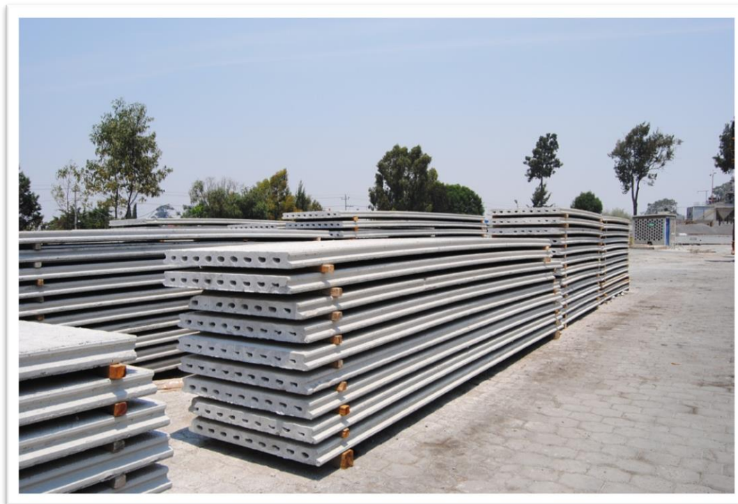
Figura 4.19. Una vez realizados los cortes, se procede a la etiquetación de acuerdo a sus dimensiones y posición que ocupara en la obra, se transportan las losas hasta el sitio de almacenaje listas para su embarque.
