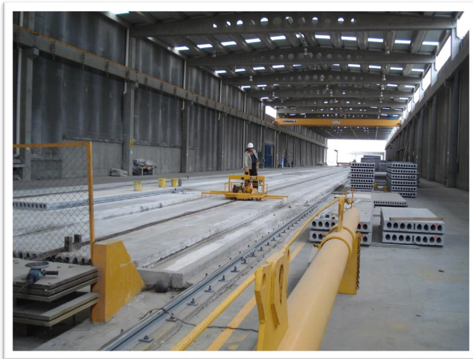
Figuras 2.45 y 2.46. Líneas de producción de losa alveolar tipo Spancrete en planta Tecámac
