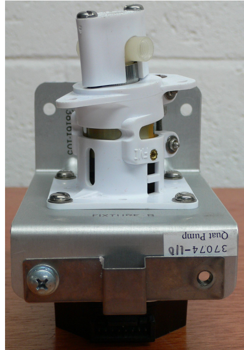
Fig.-8.10a Bomba de solución genérica (MUP y/o WASH)
