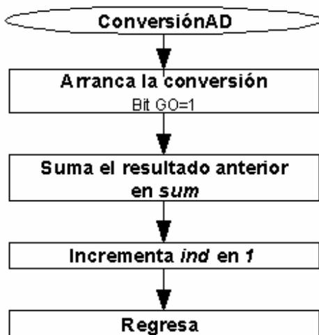
Fig. 3.3. Diagrama de bloques de la función *ConversionAD*
