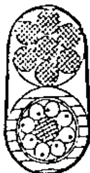
Fig. 5.-18 Cable óptico unido a mensajero
