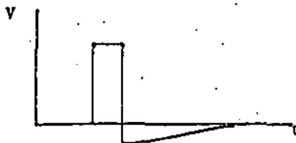
Figura III.3. Pulso acoplado en CA.
