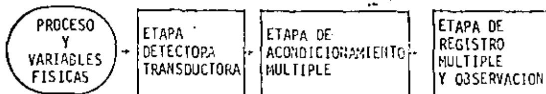
Fig. 4 Diagrama esquemático de un Sistema de Adquisición de datos generalizado (SAD).
