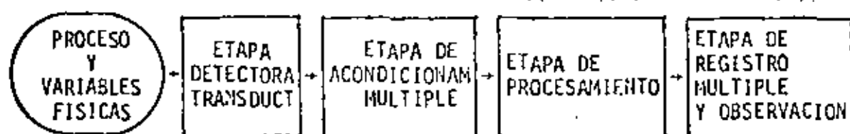
Fig. 5 Diagrama esquemático de un sistema de adquisición y procesamiento de datos generalizado (SAPD).
