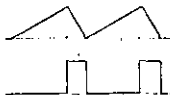
Figura 21. Conversión de rampa a impulsos
