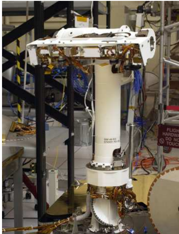
Fig. 4a cámara panorámica, la cual consta de “ojos” gemelos para imágenes estereoscópicas
