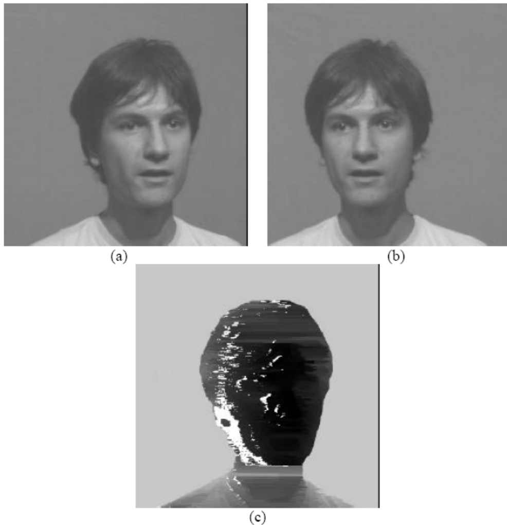
Figura 3i (a) la vista izquierda y (b) la vista derecha pertenecientes al par de una imagen estereoscópica, (c) campo de disparidad en la imagen estereoscópica representado con valores de gris (el color negro indica el primer plano, el gris el fondo y el color blanco indica oclusión de puntos).
