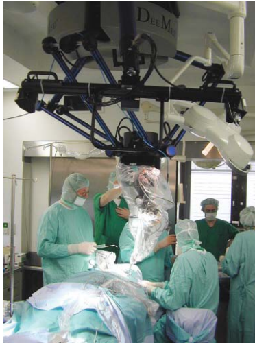
Figura 1.8: SurgiScope en acción en una cirugía robótica en el Laboratorio Humboldt de la Universidad de Berlín
