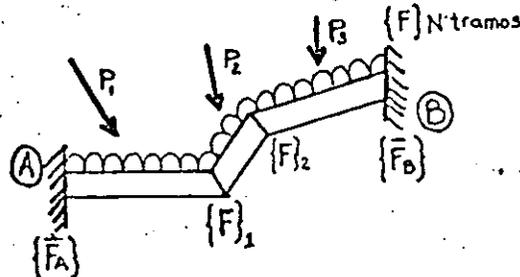
FIG. 6.- Barra  $\boxed{1}$  cargada y fuerzas de fijación  $\{\bar{F}_A\}$  y  $\{F_B\}$
