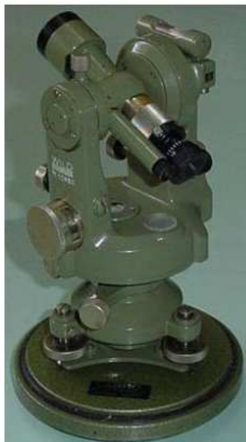
Figura 2.1.4 Teodolito Brújula Wild T0 con micrómetro óptico
