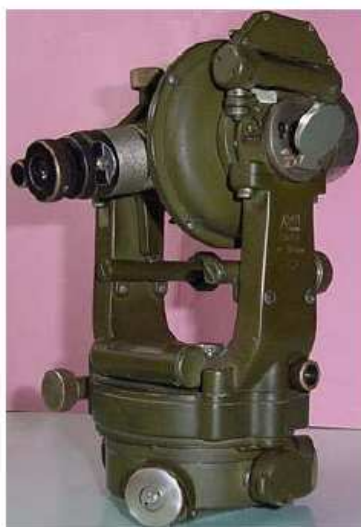
Figura 2.1.5 Teodolito Kern DK-2 con sistema de lectura de coincidencia
