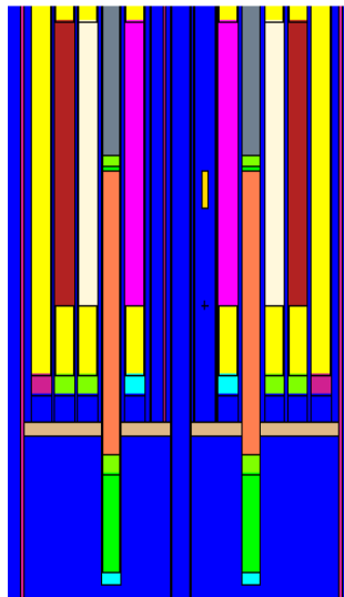
Figura 5.6. Lámina de molibdeno natural incorporada en el código en la instalación experimental B-1
