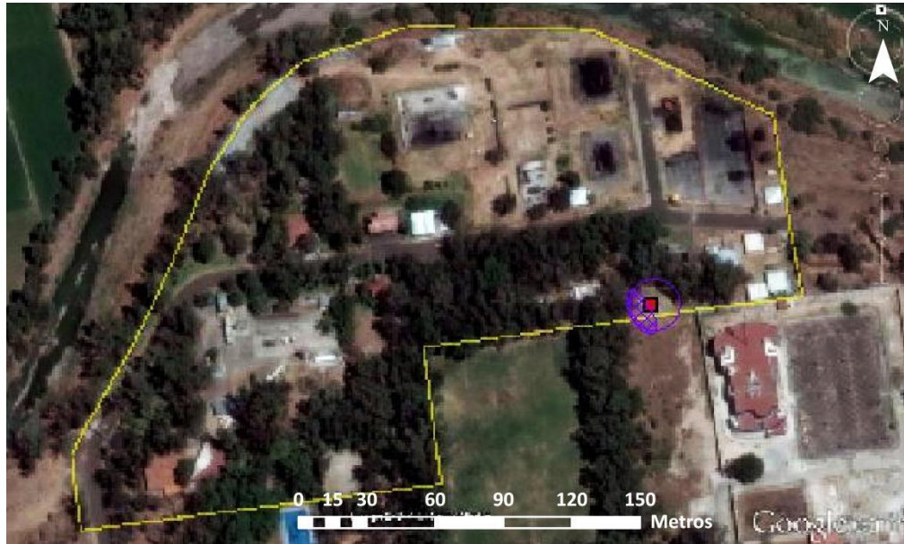
Figura 7.23. Área inflamable en condiciones de T_{\text{máx}} y H_{\text{Rmín}} en otoño, por fuga desde el espacio de vapor.
