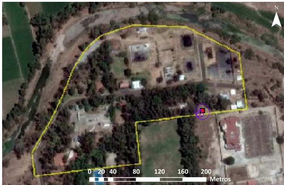
Figura 7.26. Área inflamable en condiciones de T_{\text{mín}} y H_{\text{Rmáx}} en primavera, por fuga desde el espacio del líquido.
