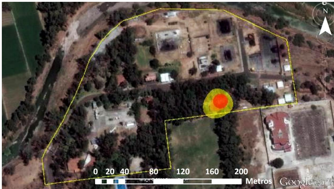
Figura 7.66. Radios de afectación por radiación generada en el incendio de charco, utilizando el programa EFFECTS.
