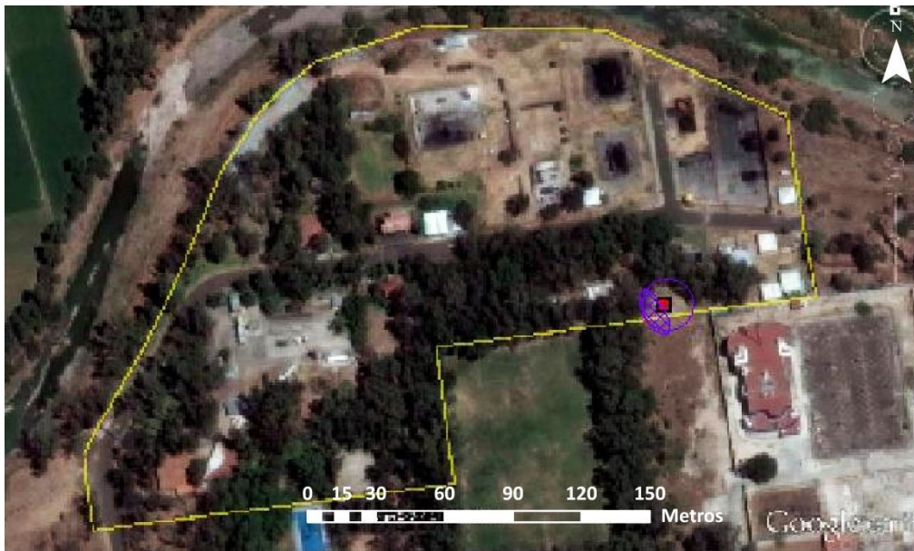
Figura 7.24. Área inflamable en condiciones de T_{\text{máx}} y H_{\text{Rmín}} en Invierno, por fuga desde el espacio de vapor.
