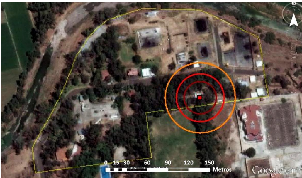
Figura 7.53. Radios de afectación por radiación del incendio de charco en condiciones de T_{m\acute{a}x} y H_{Rm\acute{i}n} .
