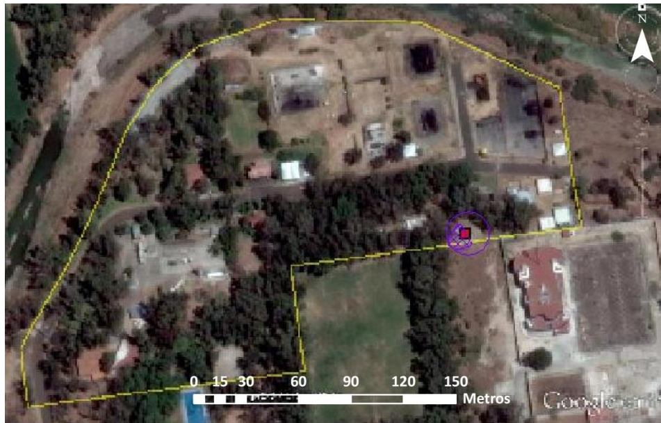
Figura 7.32. Área inflamable en condiciones de T_{\text{máx}} y H_{\text{Rmín}} en verano, por fuga desde el espacio del líquido.
