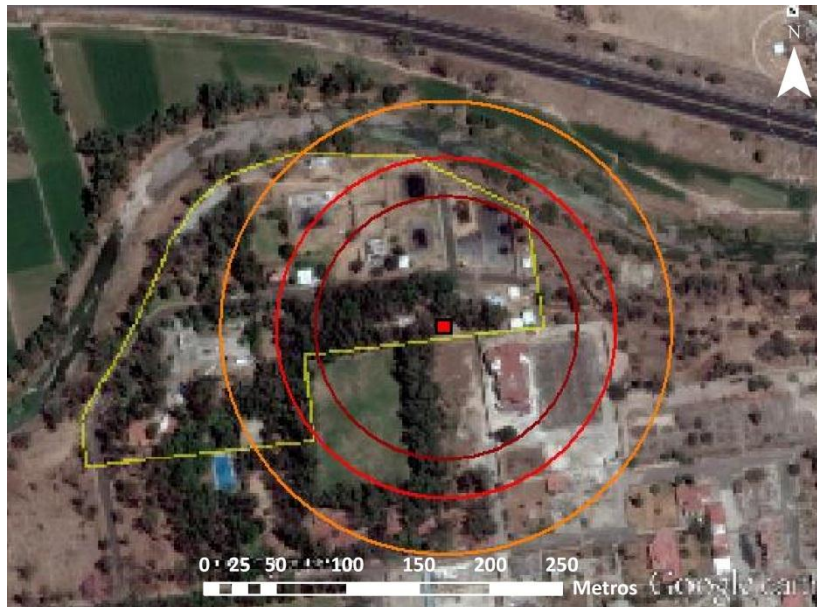
Figura 7.39. Radios de afectación por radiación de la bola de fuego en condiciones de T_{\text{máx}} y H_{\text{Rmín}} .
