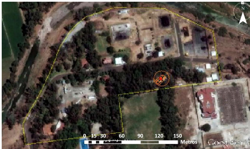
Figura 7.47. Área inflamable por llamarada de Gasolina en condiciones de T_{\text{mín}} y H_{\text{Rmáx}} en verano.
