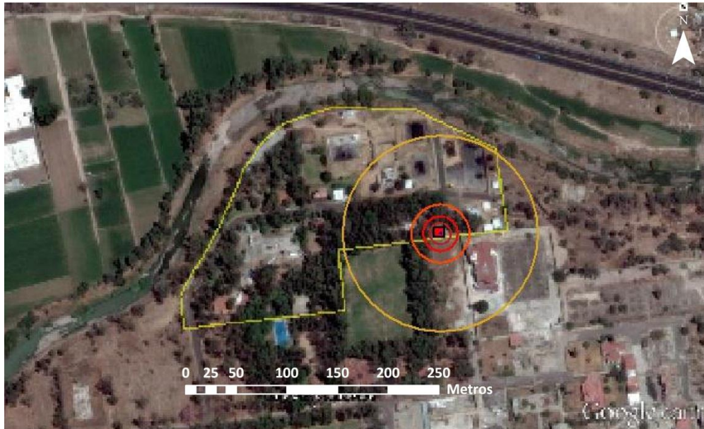
Figura 7.35. Radios de afectación por nube explosiva de Gas L.P.
