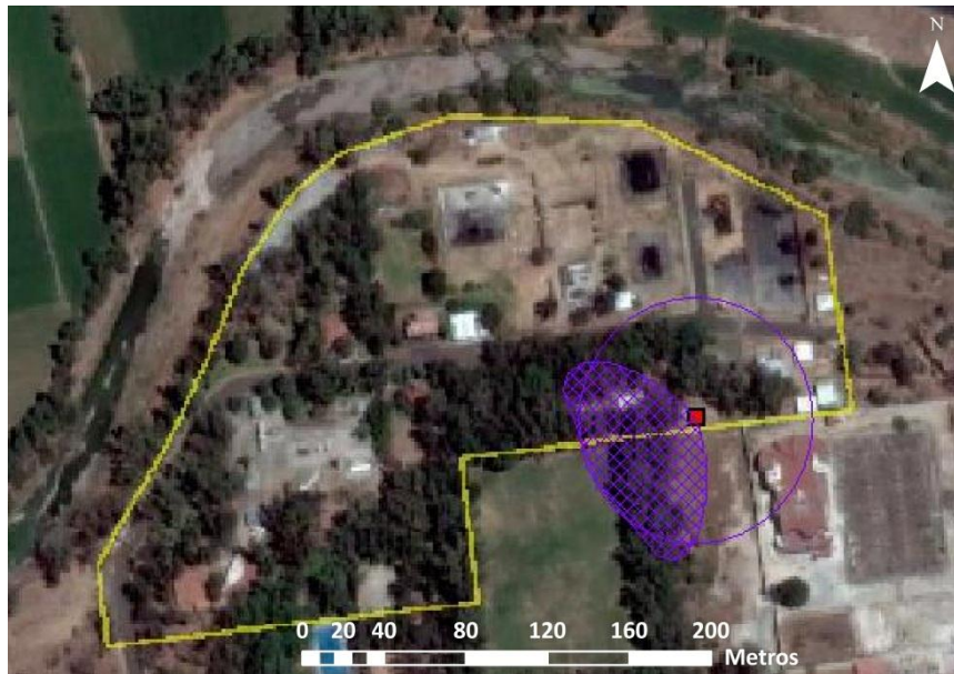
Figura 7.28. Área inflamable en condiciones de T_{\text{mín}} y H_{\text{Rmáx}} en otoño, por fuga desde el espacio del líquido.
