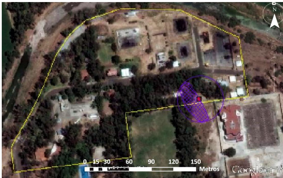
Figura 7.33. Área inflamable en condiciones de T_{\text{máx}} y H_{\text{Rmín}} en otoño, por fuga desde el espacio del líquido.
