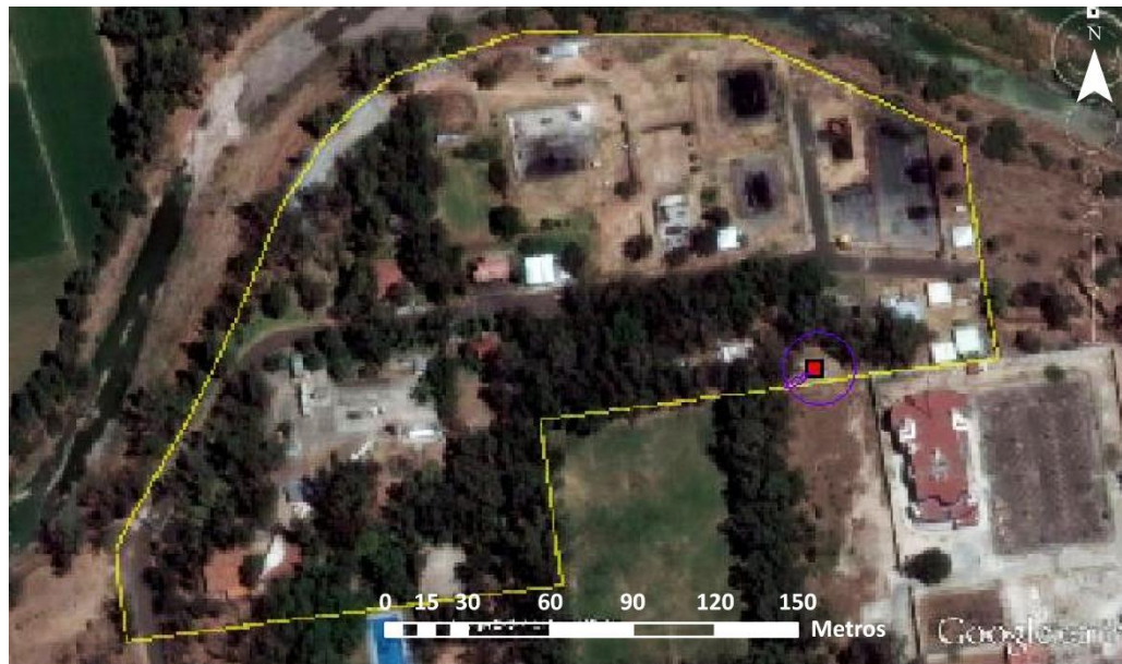
Figura 7.22. Área inflamable en condiciones de T_{\text{máx}} y H_{\text{Rmín}} en verano, por fuga desde el espacio de vapor.
