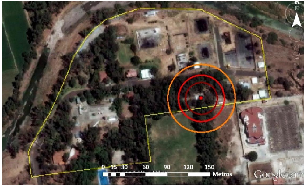
Figura 7.51. Radios de afectación por radiación del incendio de charco en condiciones de T_{\text{mín}} y H_{\text{Rmáx}} .
