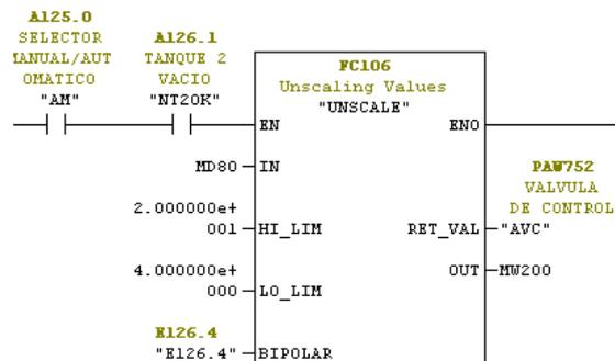
Figura 3.18 Boque des-escalar.
