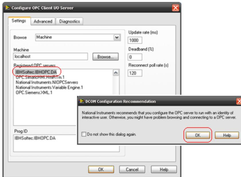
Figura 4.3 Configuración de OPC Client I/O Server.
