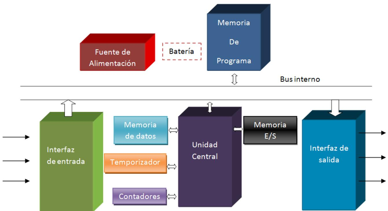
Figura 2.2 Diagrama de bloques básico de PLC.
