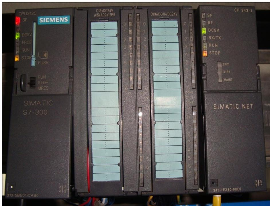
Figura 3.14 PLC S7-300 con modulo Ethernet.
