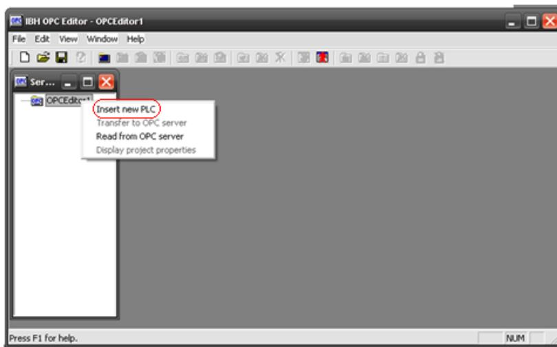
Figura 5.5 Insert New PLC en OPC server.
