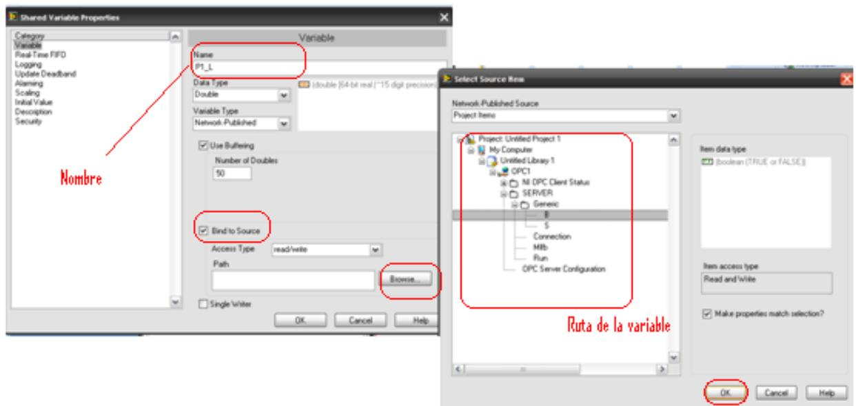
Figura 4.5 Configuración de variables.
