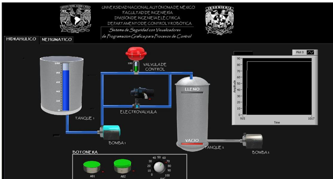
4.10 Vista final de SCADA hidráulico en LabView.
