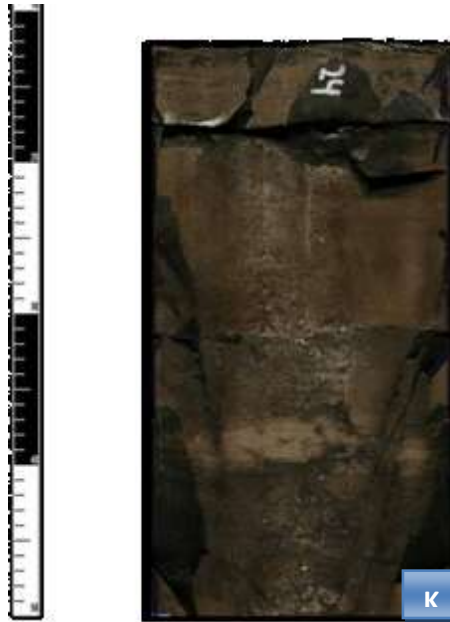
Figura 3.14.K. Espesor de 3100 m. wackestone blanco a crema con escasas microfracturas selladas por calcita.
