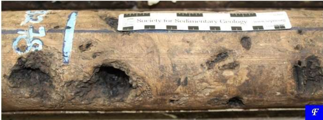
Figura 3.11.F. Profundidad 3350 m. Porosidad intrafósilar en Radiolarios, presenta impregnación de hidrocarburos.
