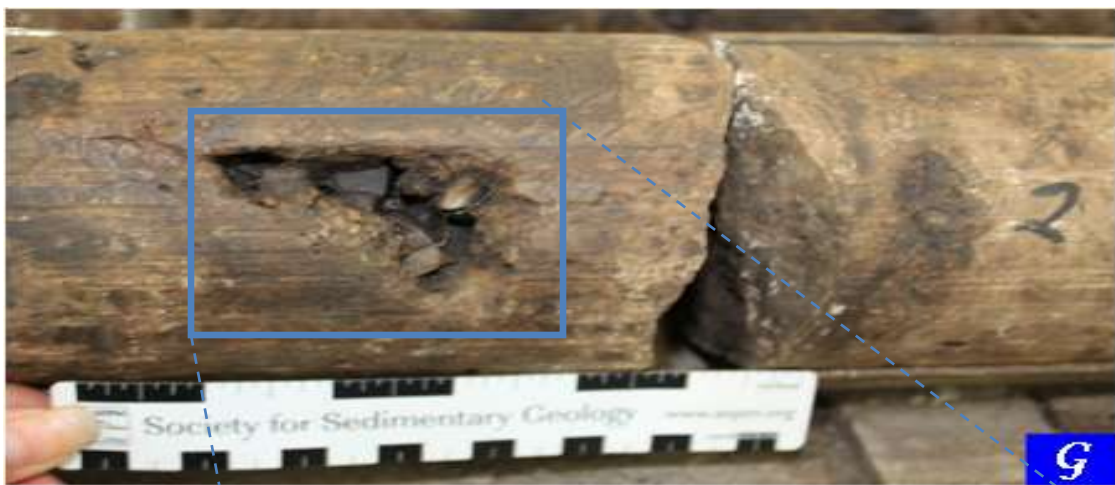
Figura 3.11.F. Profundidad 3350 m. Porosidad intrafósilar en Radiolarios, presenta impregnación de hidrocarburos.
