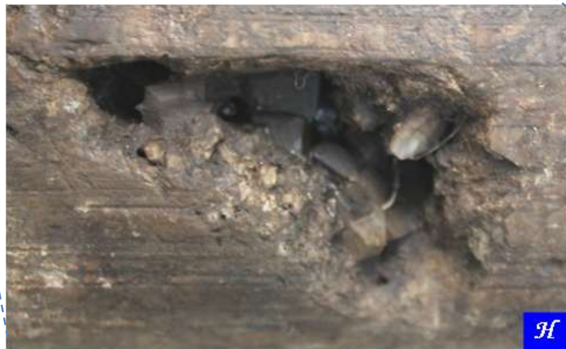
Figura 3.12. G-H. Profundidad 3350-3360 m. Cavidades interparticular con crecimiento de cristales de calcita presenta porosidad e impregnación de hidrocarburos.
