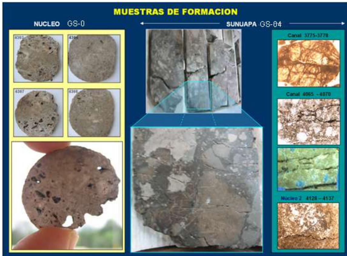
Figura 4.11. Muestras de formación en donde se observan sistemas de poros predominantes. Porosidad primaria en matriz (Núcleo GS-0). Porosidad secundaria en brechas por fracturamiento (pozo GS-04) del campo Sunuapa (PEMEX, 2013).
