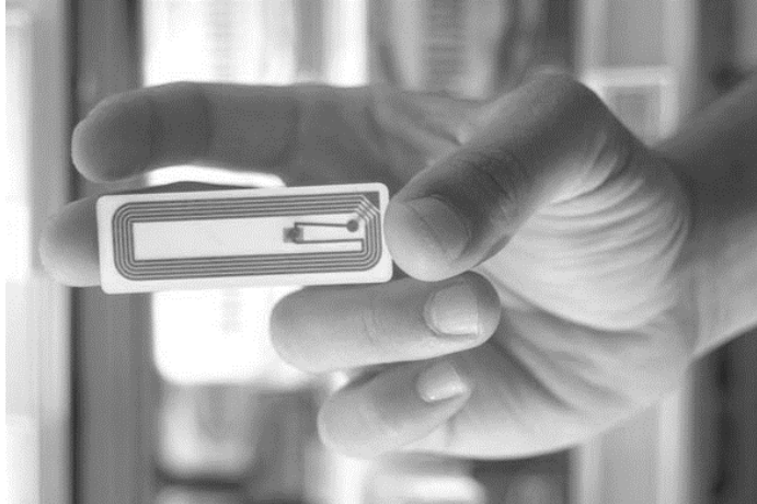
Figura 2.3 Etiqueta RFID pasiva
