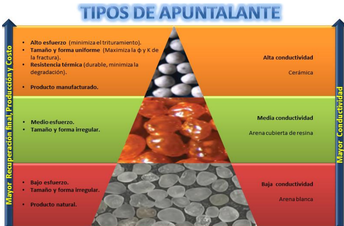
Figura 4.0 Tipos de apuntalantes existentes ordenados según su costo y conductividad. Fuente: Elaboración propia.
