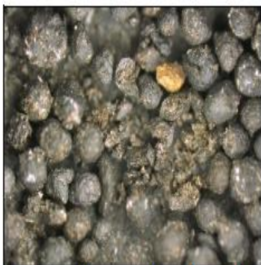
Figura 2.14 Presencia de "crushing" generado durante el ensayo de empotramiento.
