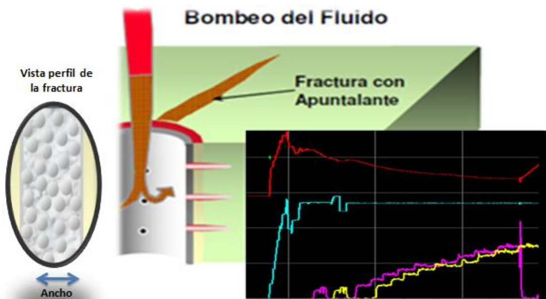
Figura 4.6. Etapa de desplazamiento del apuntalante (bombeo del flush) con vista de perfil de la fractura y gráfica de bombeo. Fuente: Halliburton 2013.
