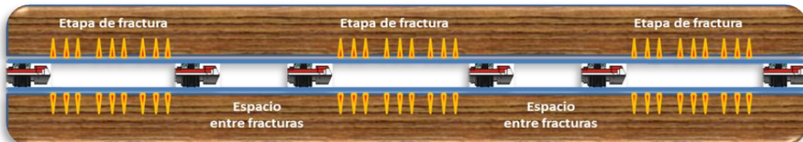
Figura 6.10. Tres etapas de fractura con tres clusters lo que equivalen a una fractura. Fuente: CSUR 2011.
