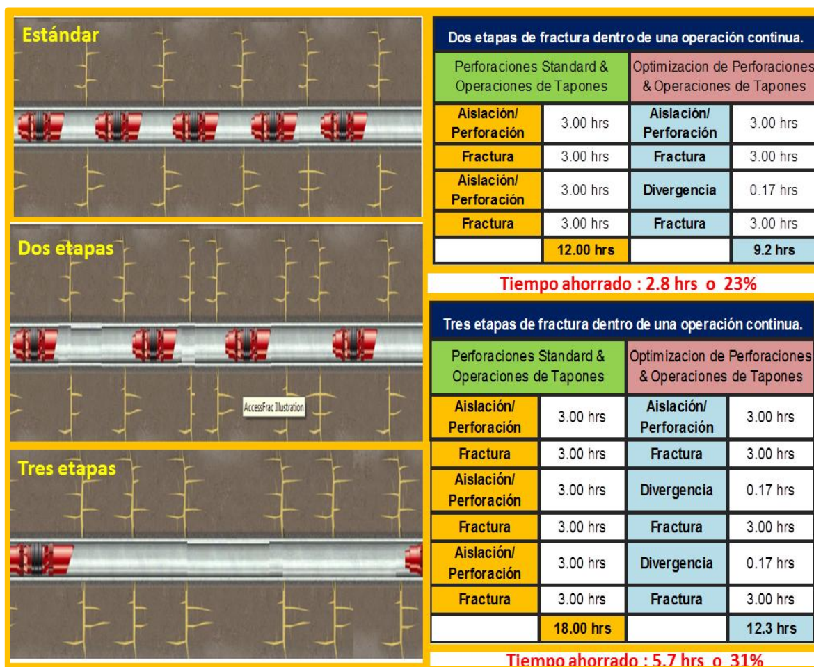
Figura 5.9 La optimización del número de clusters puede llevar ahorros en tiempos de operativos. Fuente: Halliburton 2011.
