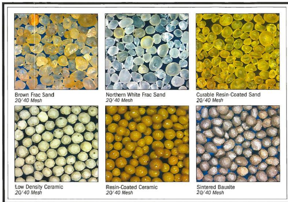
Figura 4.21 Tipos de apuntalantes existentes en el mercado. Fuente: Ybáñez 2011.
