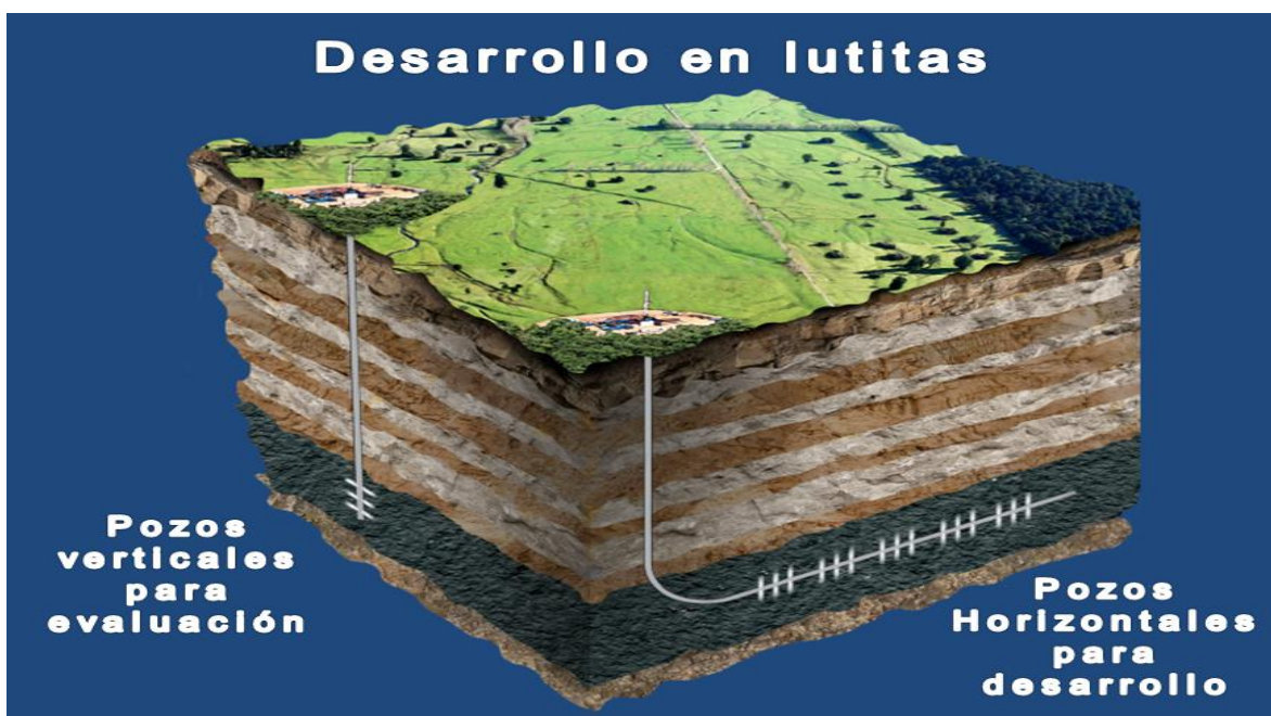
Figura 6.3. Incremento del área de contacto con el yacimiento de un pozo horizontal comparado con uno vertical. Fuente: East Resources inc.
