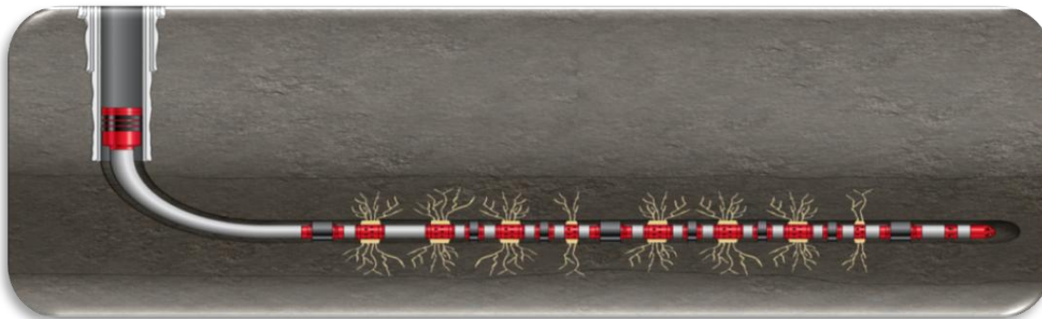
Figura 6.14. Agujero descubierto (Camisas deslizables activada por bolas) Fuente: Halliburton 2012.
