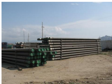
Tubería de Perforación.
