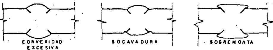
PERFILES DEFECTUOSOS DE SOLDADURA A TOPE
