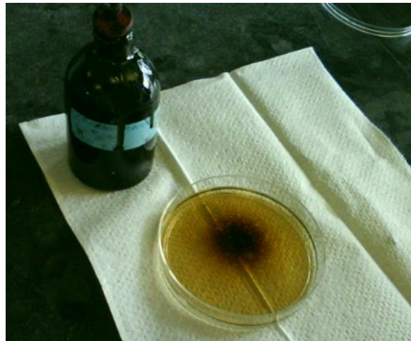
Figura 2.7 Dispersión del aceite en el agua destilada para realizar la prueba de la gota.
