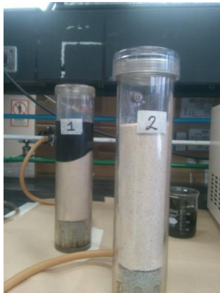
Figura 2.5. Impregnación de columnas.
