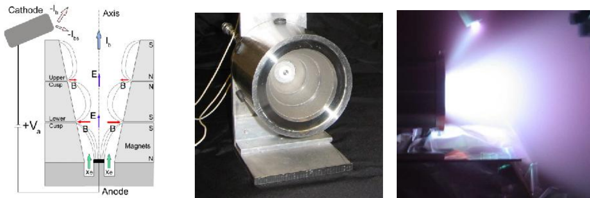
Figura 4.16: (A la derecha) Diagrama esquemático de un propulsor DCFT. (En medio) Ejemplo de un propulsor DCFT. (A la izquierda) El propulsor DCFT en funcionamiento. (Crédito de la imagen: Courtney Daniel MIT).
