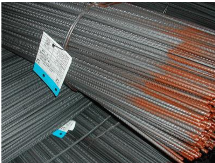
Figura 2.7 Etiqueta de identificación del acero de refuerzo
