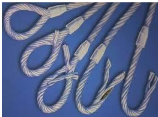
Fig. 9.12 Estrobo en proceso de encasquillarse
