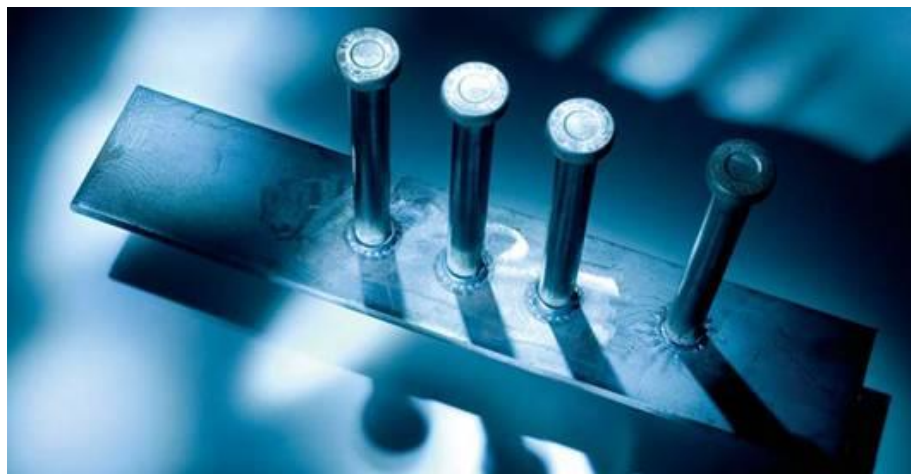
Fig. 8.5. Accesorio a base de soldadura de vástagos
