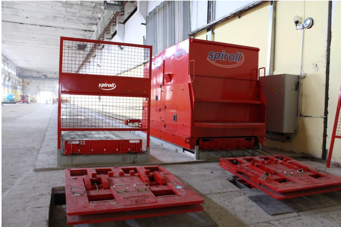
Figura. 6.4 Escudo para protección de los trabajadores.
