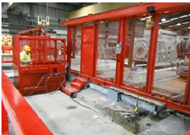
Figura 3.a Escudos de protección contra ruptura de torón. Fuente: Manual for Fabrication of Precast Prestressed Concrete Products” elaborado por el Departamento del Transporte de Illinois, EUA
