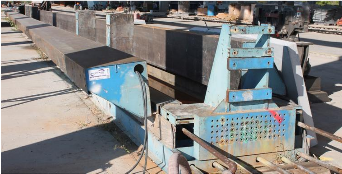
Figura 2.5 Molde autotensable para viga “T” invertida
