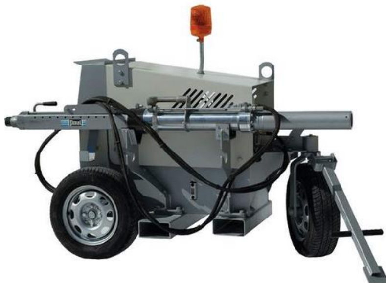
Figura 3.c Gato monotorón para presfuerzo, con sirena que funciona como señal visual
