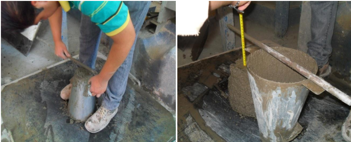
Fig. 5.1 Prueba de revenimiento realizada a una mezcla de CRF de Polipropileno
