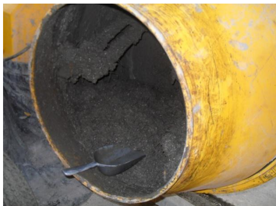
Fig. 4.2 Ejemplo: mezcla de concreto reforzado con fibras de polipropileno “M5”, con un consumo 2.3 \text{ kg/m}^3
