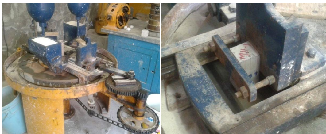
Fig. 5.12 Equipo de prueba para determinar el desgaste en el concreto reforzado con fibras
