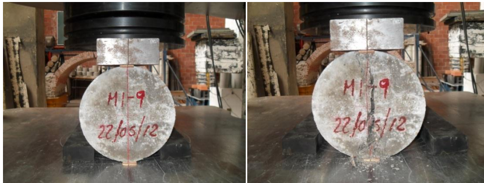
Fig. 5.9 Configuración de la prueba para obtener la resistencia a tensión por compresión diametral (prueba brasileña), espécimen correspondiente a la mezcla de CRFA con un consumo de fibra de 40 kg/m 3
