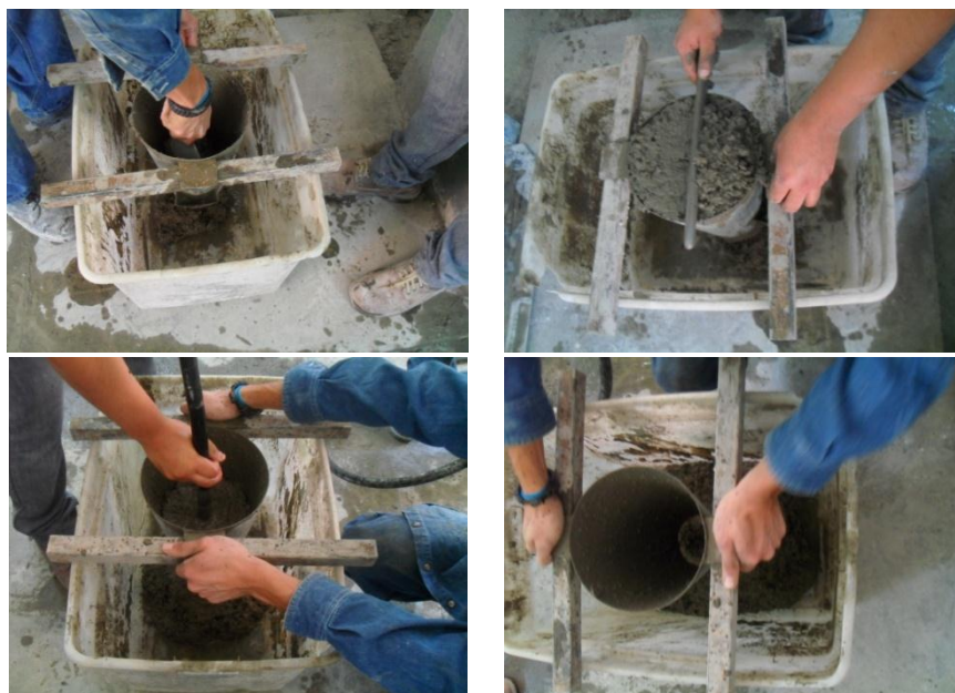
Fig. 5.3 Configuración del método de prueba cono invertido empleado para evaluar los las mezclas de CRF estudiadas
