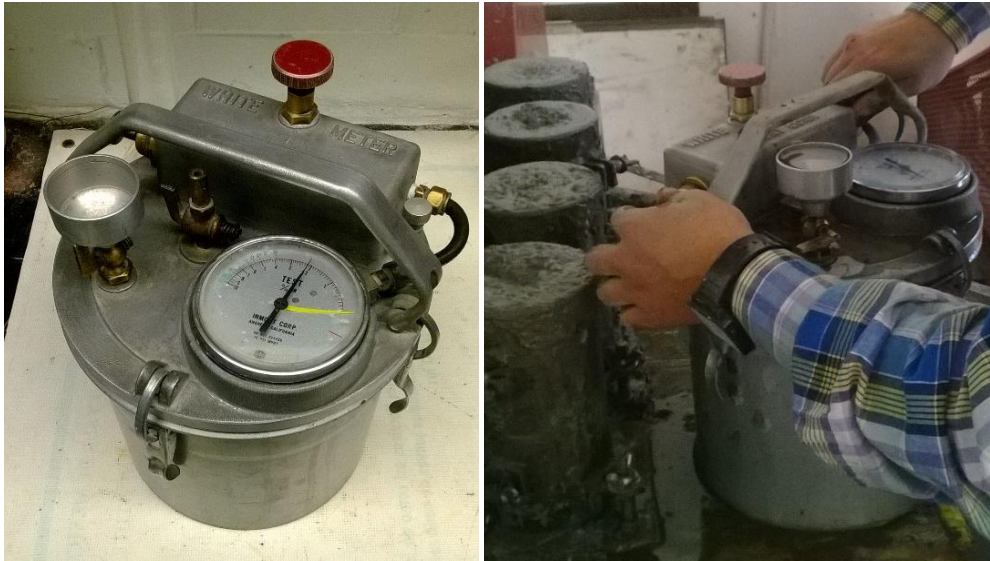
Fig. 5.2 Equipo empleado para obtener el contenido de aire y peso volumétrico del concreto
