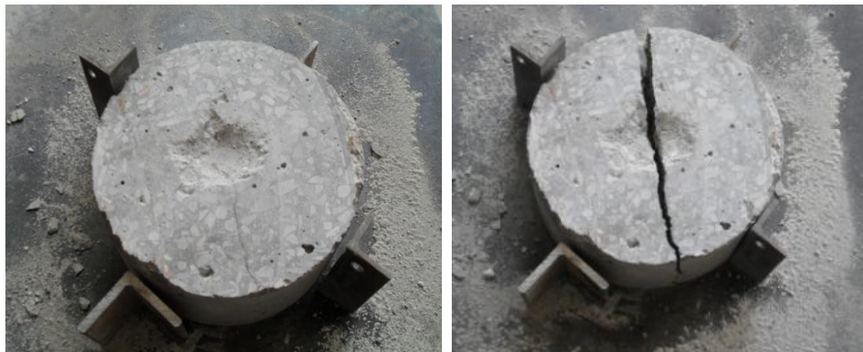
Fig. 5.13 Espécimen requerido para la prueba de impacto, ejemplo: mezcla testigo sin fibras "M1" (Izquierda primera grieta, derecha última grieta)
