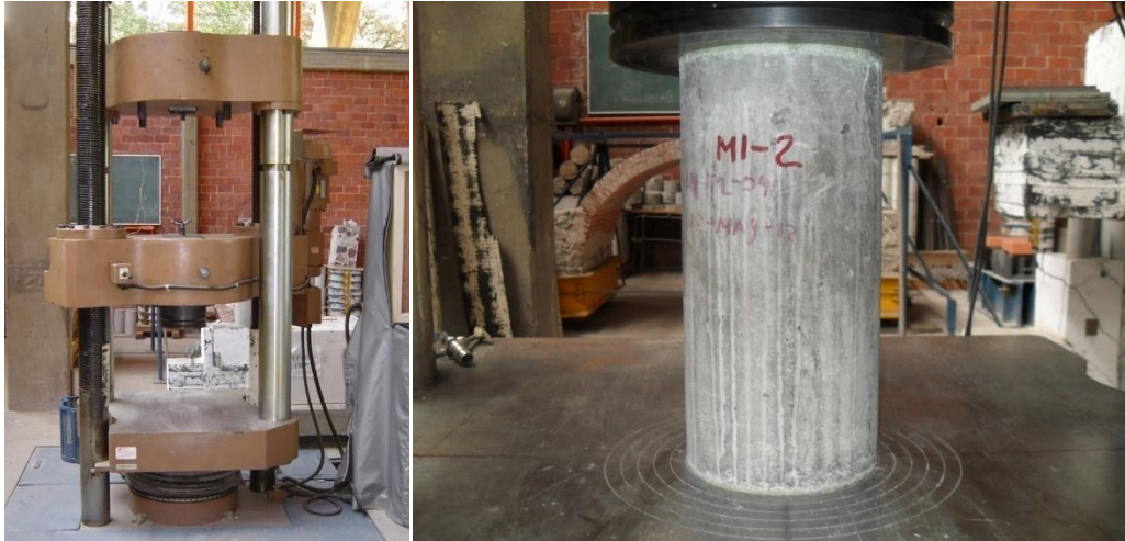
Fig. 5.6 A la izquierda prensa universal modelo SATEC utilizada, a la derecha espécimen de CRF listo para hacer ensayo
