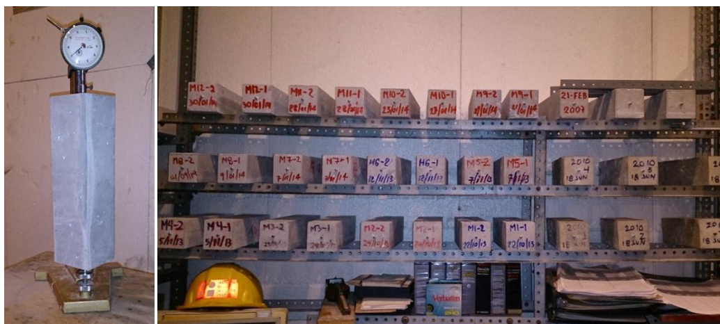
Fig. 5.18 A la izquierda, comparador de longitudes empleado para determinar la contracción por secado, a la derecha, especímenes resguardados en la cámara seca
