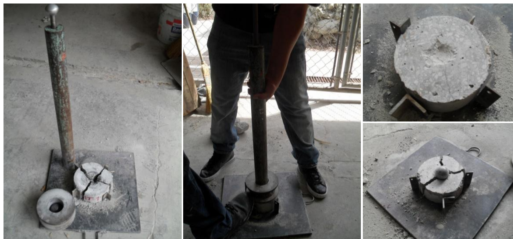
Fig. 5.14 Configuración para realizar la prueba y determinar la resistencia al impacto de concreto
