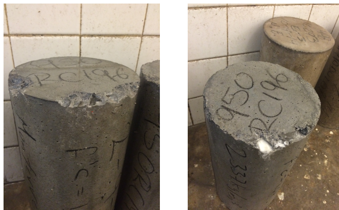
Figura 3.5: Cilindro maltratado durante el traslado al laboratorio del ii
