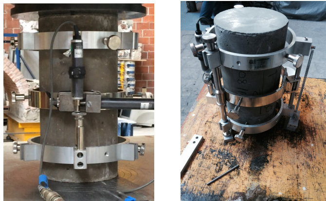
Figura 3.8: Anillos en muestras de concreto
