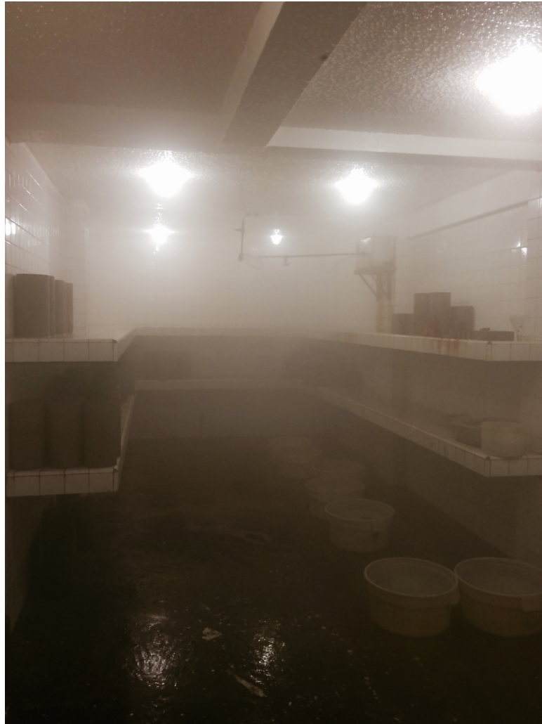
Figura 3.4: Cuarto de curado, Instituto de Ingeniería UNAM
