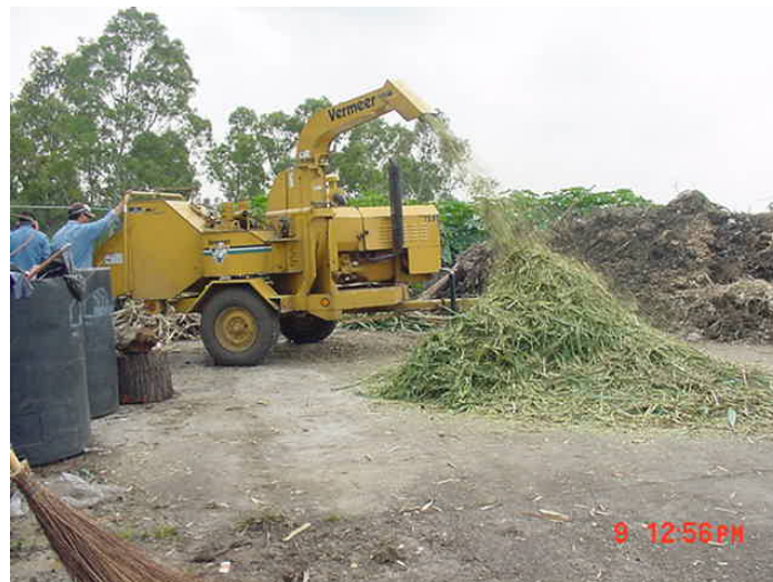
Figura 3.4 Reducción de tamaño del material biológico del corte de carrizos
