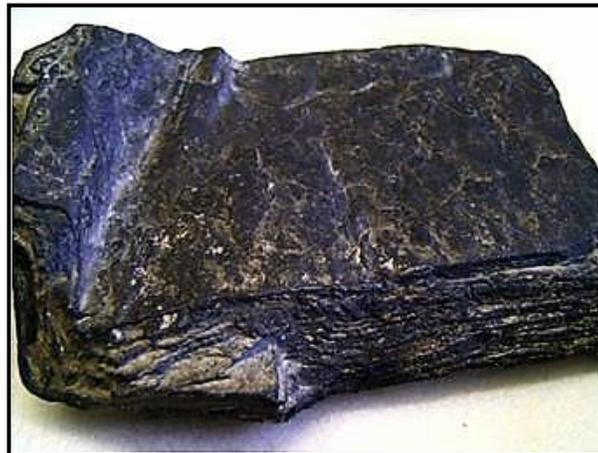
**Fig. 2.4** Muestra de una lutita donde se aprecia su fisibilidad (laminación). (Tomada de Babst Calland, 2011).
