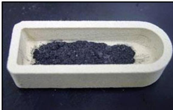
**Fig. 3.28** Bote de combustión con muestras de núcleos de formaciones ricas en materia orgánica. (Tomada de ASTM International, 2010).
