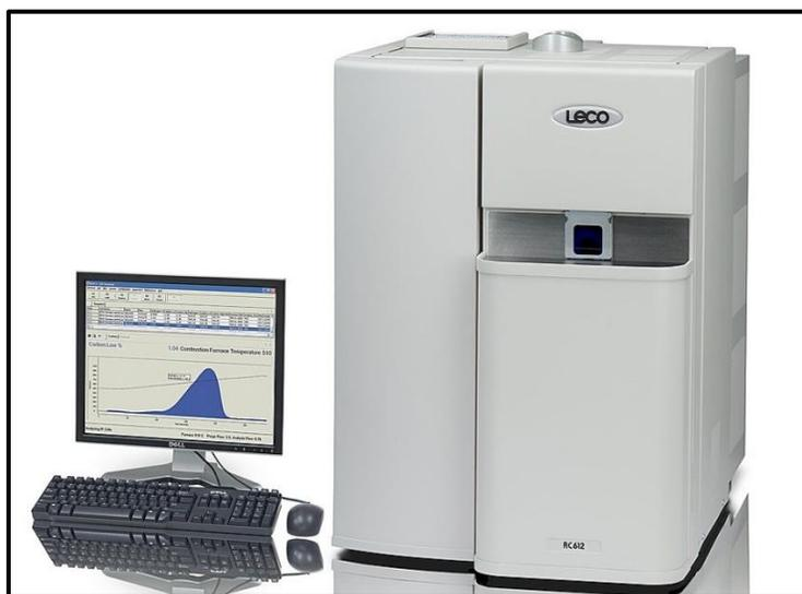
**Fig. 3.27** Analizador de COT, Carbono superficial, libre e inorgánico marca LECO® modelo RC612.
