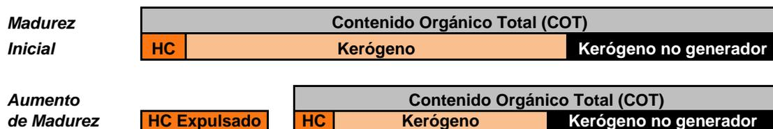
**Fig. 2.16** La madurez y expulsión produce una reducción de kerógeno y COT dada la cantidad de carbono expulsado como aceite y/o gas. (Modificada de Jarvie, D.,1999).
