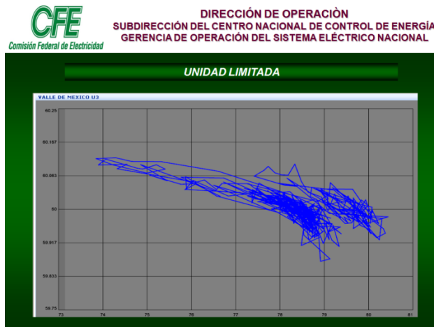
Figura 1.8. Gráfica de una Unidad Limitada (Valle de México Unidad 3). El eje de las ordenadas corresponde a la frecuencia [Hz] y el de las abscisas a la potencia suministrada por la unidad [MW].
