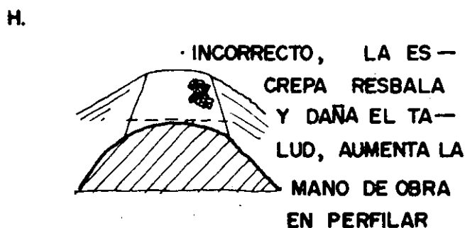
FORMACION DE TERRAPLENES
