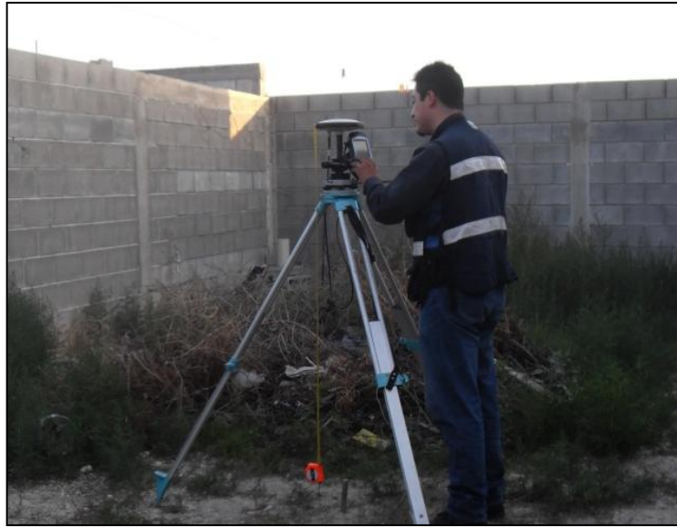
Fotografía 5 Instalación de la Base GPS.
